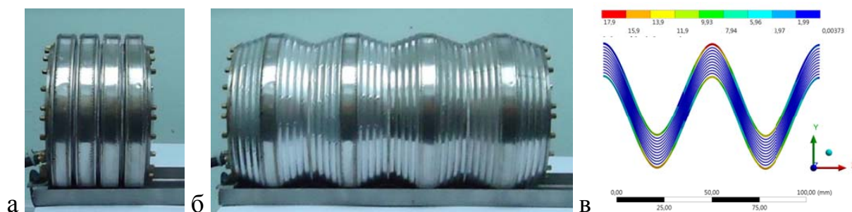
Рис. 3. Випробувальний зразок перетворюваного модуля в компактному (а) і розкритому (б) стані; фрагмент чисельної моделі розкриття двошарової несучої оболонки модуля з алюмінієвого сплаву з заповнювачем з листового поліетилентерефталату (в)
