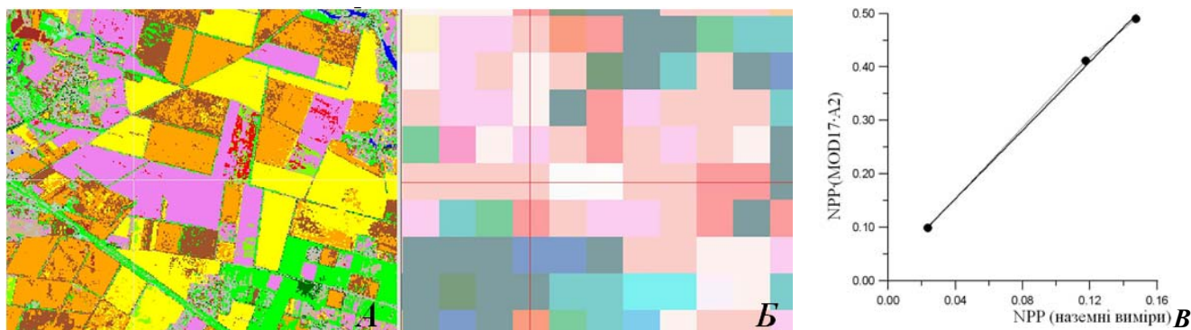
Рис. 1. Зіставлення класифікованого зображення за результатами обробки знімків Landsat-8 (А) з пікселами знімку MOD17A2 (Б) для визначення пікселу MOD17A2, для якого виконано зіставлення з наземними даними та побудована кореляційна залежність між значеннями NPP за продуктом MOD17 A2 і наземними вимірами для озимої пшениці сорту “Скаген” в Баришівському районі Київської області (В).
