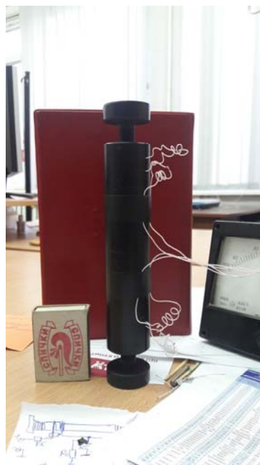
Рис. 5. Конструкція та дослідний зразок акселерометра, виготовлений в ході виконання проекту.
