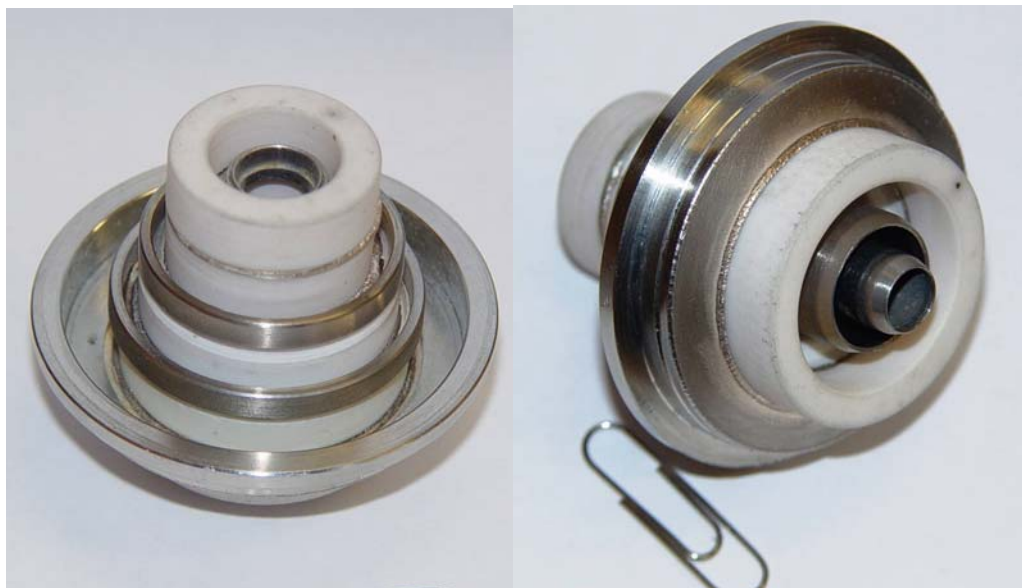
Металокерамічний зразок катодного вузла електроннопроменевого інструменту
