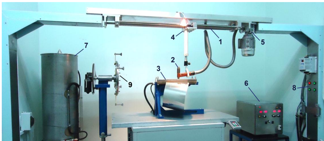
Рис.4.2. Експериментальний стенд для зварювання заготовок перетворюваних оболонок з фольгових матеріалів: 1 – механізм переміщення; 2 – плазмотрон; 3 – збирально-зварювальне пристосування з конічною заготовкою оболонки КПО; 4 – каретка механізму переміщення; 5 – двигун з редуктором; 6 – джерело живлення мікроплазмового зварювання; 7 – теплообмінний модуль плазмотрону; 8 – АС позиційного регулювання параметрів зварювального процесу; 9 – пристрій для зварювання кільцевих швів КПО
