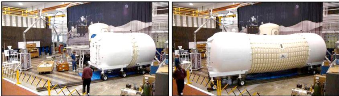
Рис..1.4. Перетворення модуля X-Hab [3]
