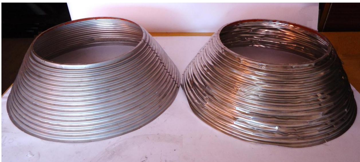
Рис.6.6 Оболонки типу a (зліва) и b (по Рис.6.5) після повторного розкриття внутрішнім тиском 10 кПа; замикальний елемент (денце) знято
