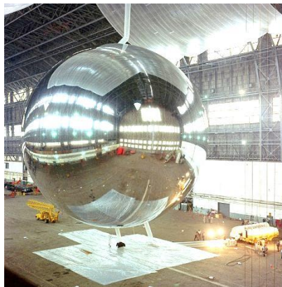
Рис. 1.1. Супутник спостереження PAGEOS масою оболонки 56 кг, діаметром 31 м. [1]
