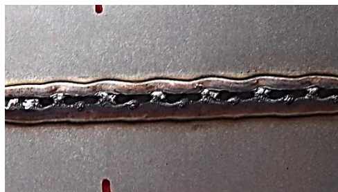
Рис.3.1 Ланцюжок пропалів, характерний для зварювання сталі AISI 321 товщиною 0,175 мм
